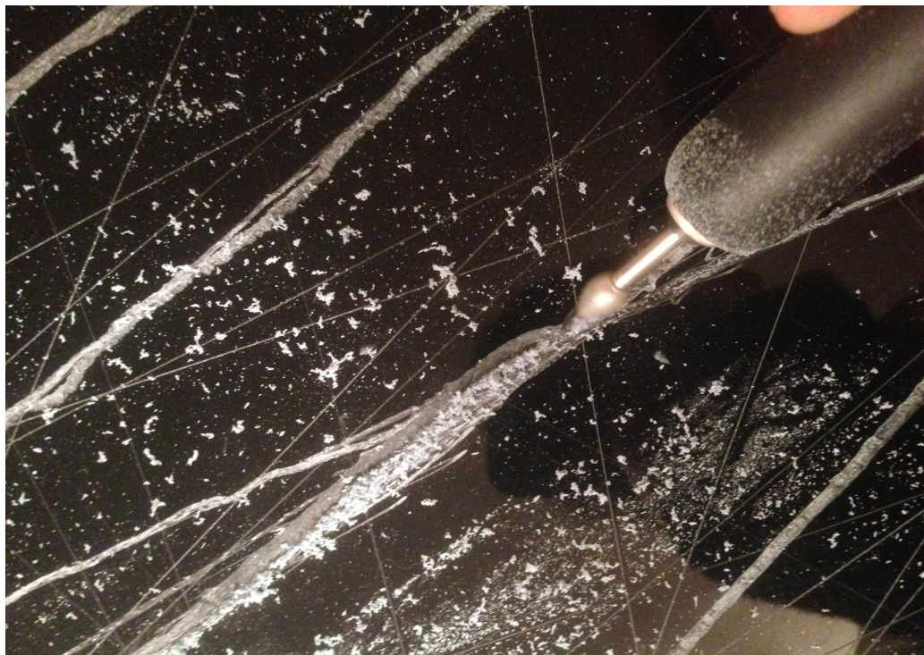
Ilustracja 5. Praca nad matrycą przy pomocy wielofunkcyjnego narzędzia dremel.
