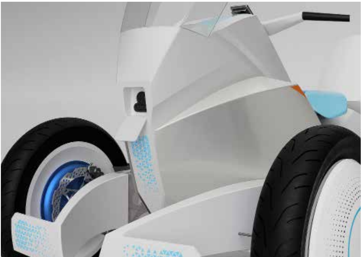
II. 141. Widok na złącze ładowania.
