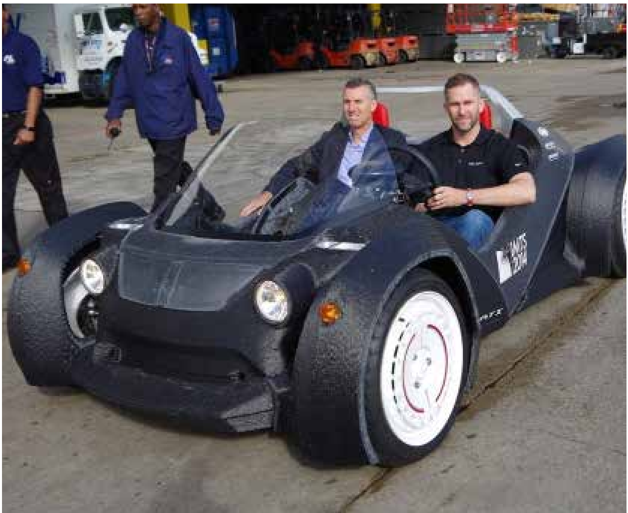
II. 39. Strati - projekt samochodu wydrukowany przy pomocy drukarki 3D. Koncepcja stworzona przez firmę Local Motors oraz Arizona State University. Autor: Carrie Jung, Źródło: http://fronterasdesk.org/content/162719/tempe-company-reveals-design-3d-printed-highway-ready-car
