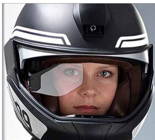
Il. 60. Kask wyposażony w system HUD, Źródło: materiały reklamowe firmy BMW.
