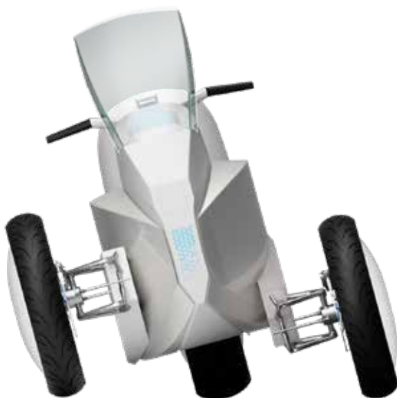
II. 128. Widok geometrii wahaczy przednich w stanie spoczynku (A) i skřęcie (B,C). Niektóre części obudowy zdjęte.
